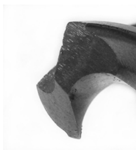
Rys. 6 Wiertło nr 6 przed próbą zużyciową
